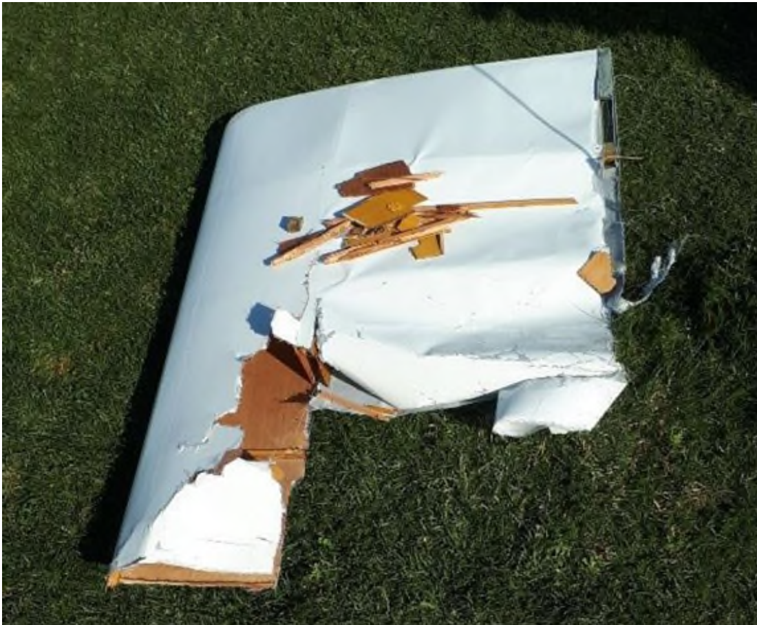
Abb. 7: Geborgene Teile des abgerissenen Höhenleitwerks der DR 400/180 R
