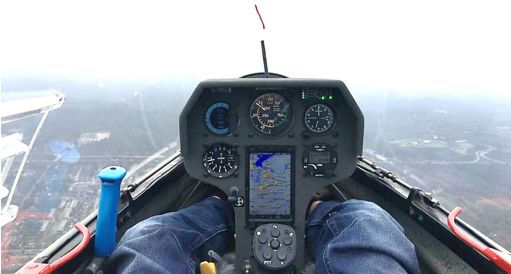
Abb. 2: Cockpit der LS4-b mit FLARM-Anzeige (obere rechte Ecke des Cockpits)
