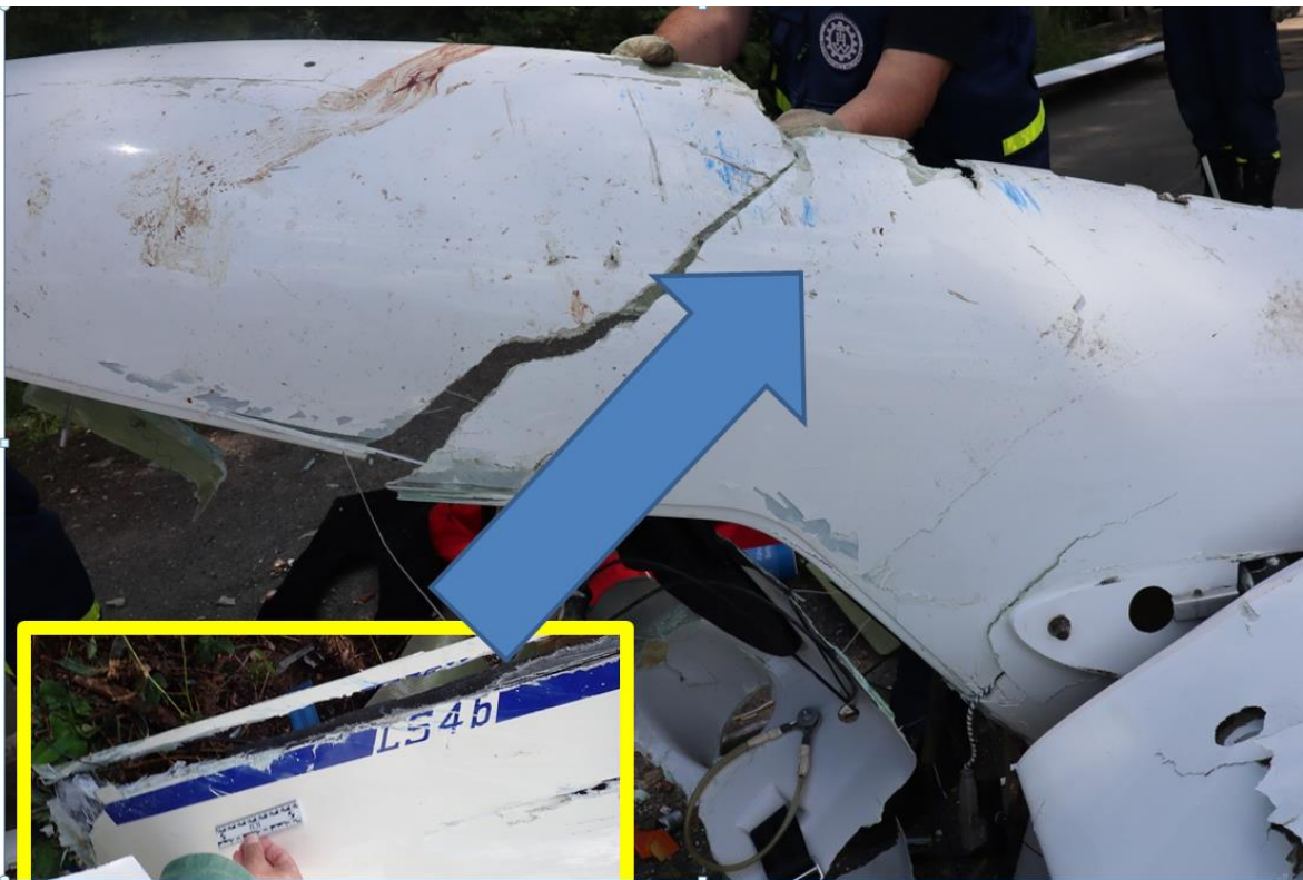
Abb. 9: Kollisionsspuren am Rumpf der DG-300 und der LS4-b
