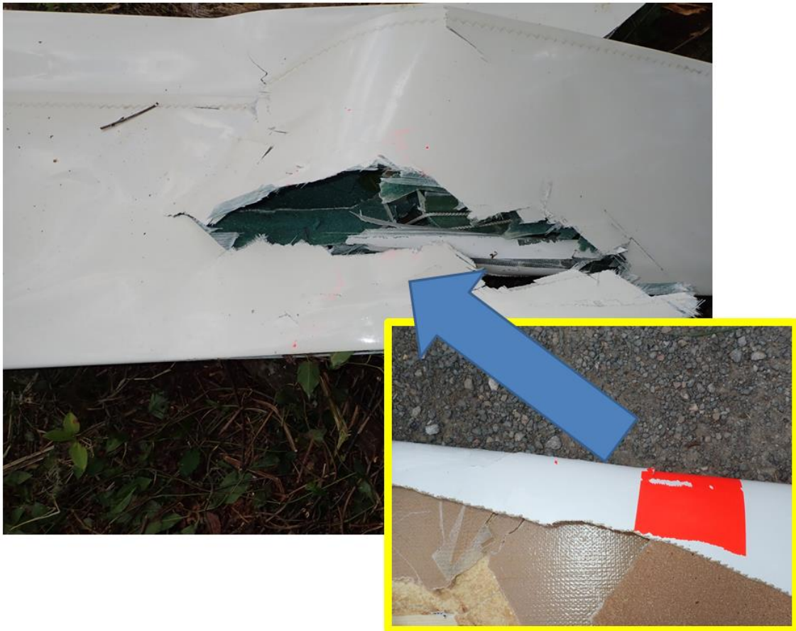
Abb. 11: Kollisionsspuren an der Tragfläche der LS4-b und am Höhenleitwerk der DG-300
