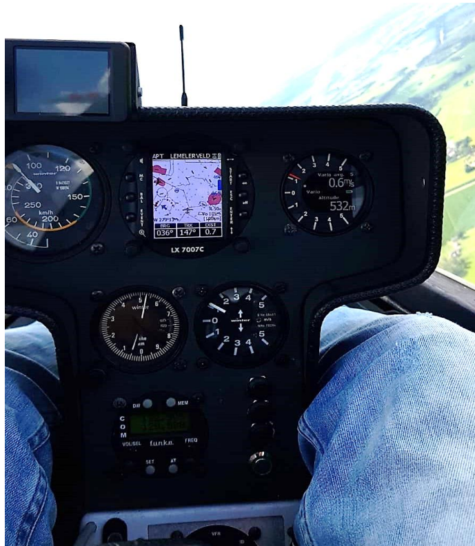
Abb. 5: Cockpit der DG-300 mit FLARM-Anzeige im Navigationsrechner (oben mittig)
