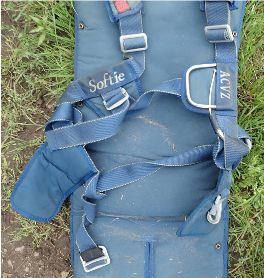
Abb. 4: Rettungsfallschirm mit offenen Beingurten
