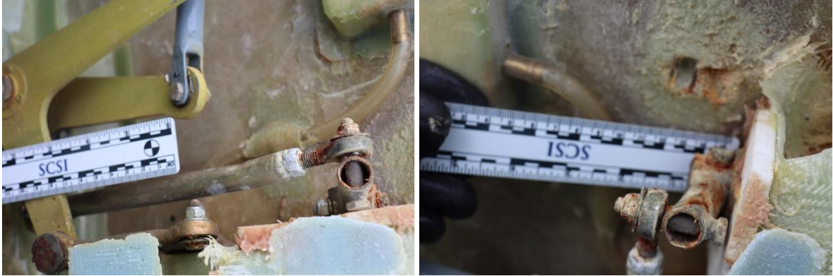
Abb. 10: Korrosion an Steuergestänge und Lagerböcken in der Tragfläche der DG-300
